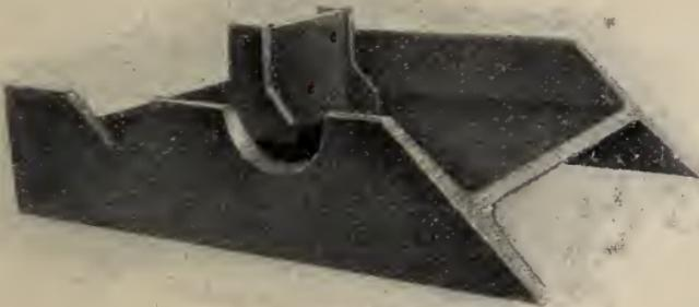
Fig. 7. Doppel-T-Träger mit Ausklinkungen autogen geschnitten.
