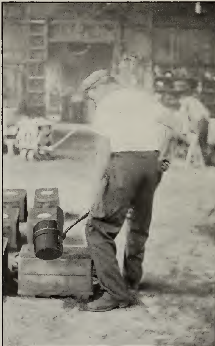
The Right Way of Pouring Hot Metal.
