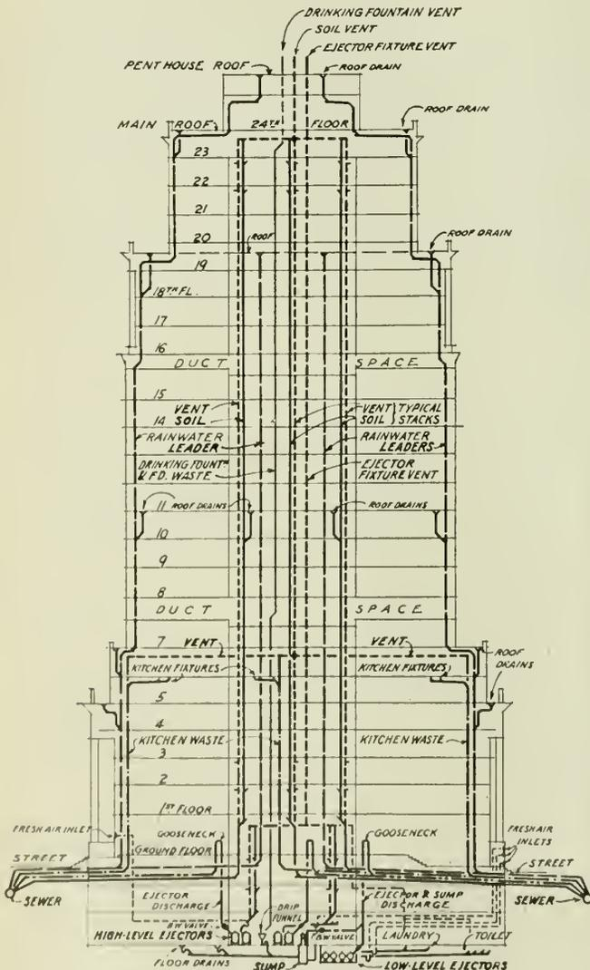
Fig. 3—Drainage Diagram.
