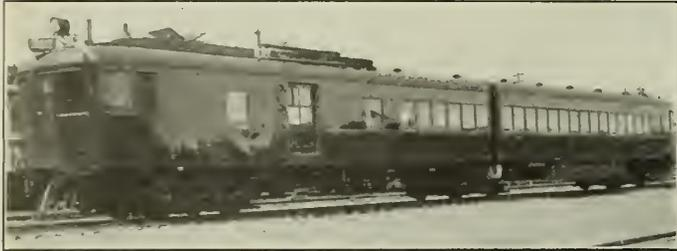
Fig. 2—200 h.p. Four-Cylinder Car.
