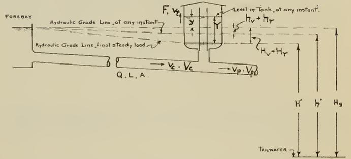
Fig. 3—Diagrammatic Layout Conduit—Surge Tank.
