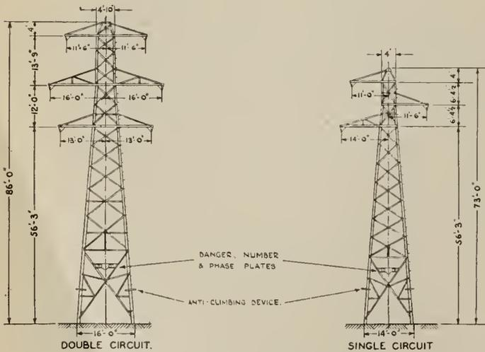
Fig. 2—Typical 132-kv. Towers.
