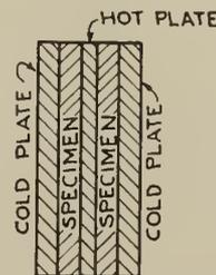
Fig. 3—Hot Plate Apparatus.
