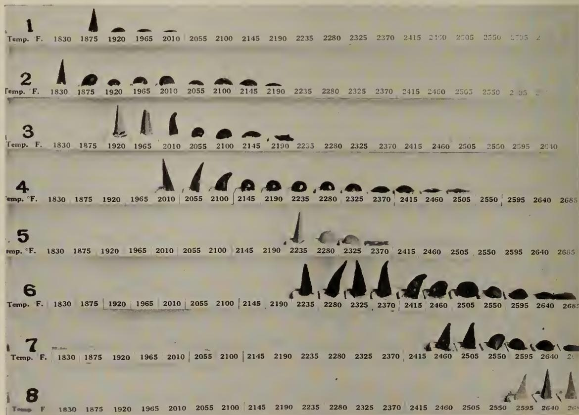
Fig. 7—Ash Fusion Cones.
